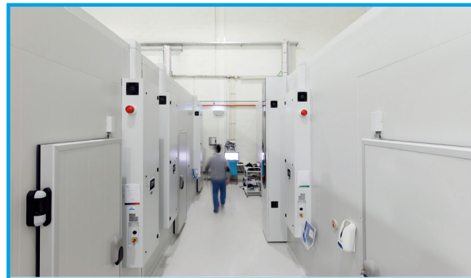
8套步入式稳定性试验箱在同一客户现场
